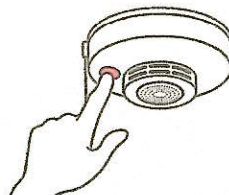
②火災の早期発見のために、住宅用火災警報器を定期的に点検し、10年を目安に交換する
